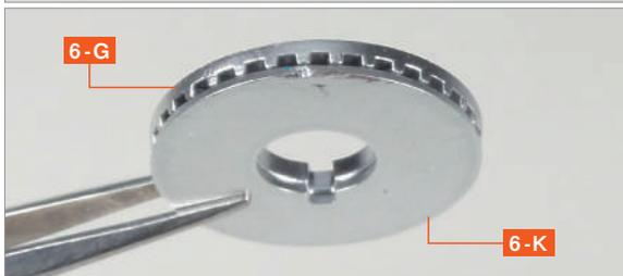
將煞車碟盤 (1) **6-G** 和煞車碟盤 (2) **6-K** 的三處銷子與洞孔對準嵌入。
